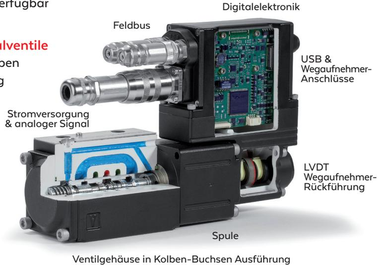
Ventilgehäuse in Kolben-Buchsen Ausführung
