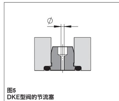
**图5 DKE型阀的节流塞**
