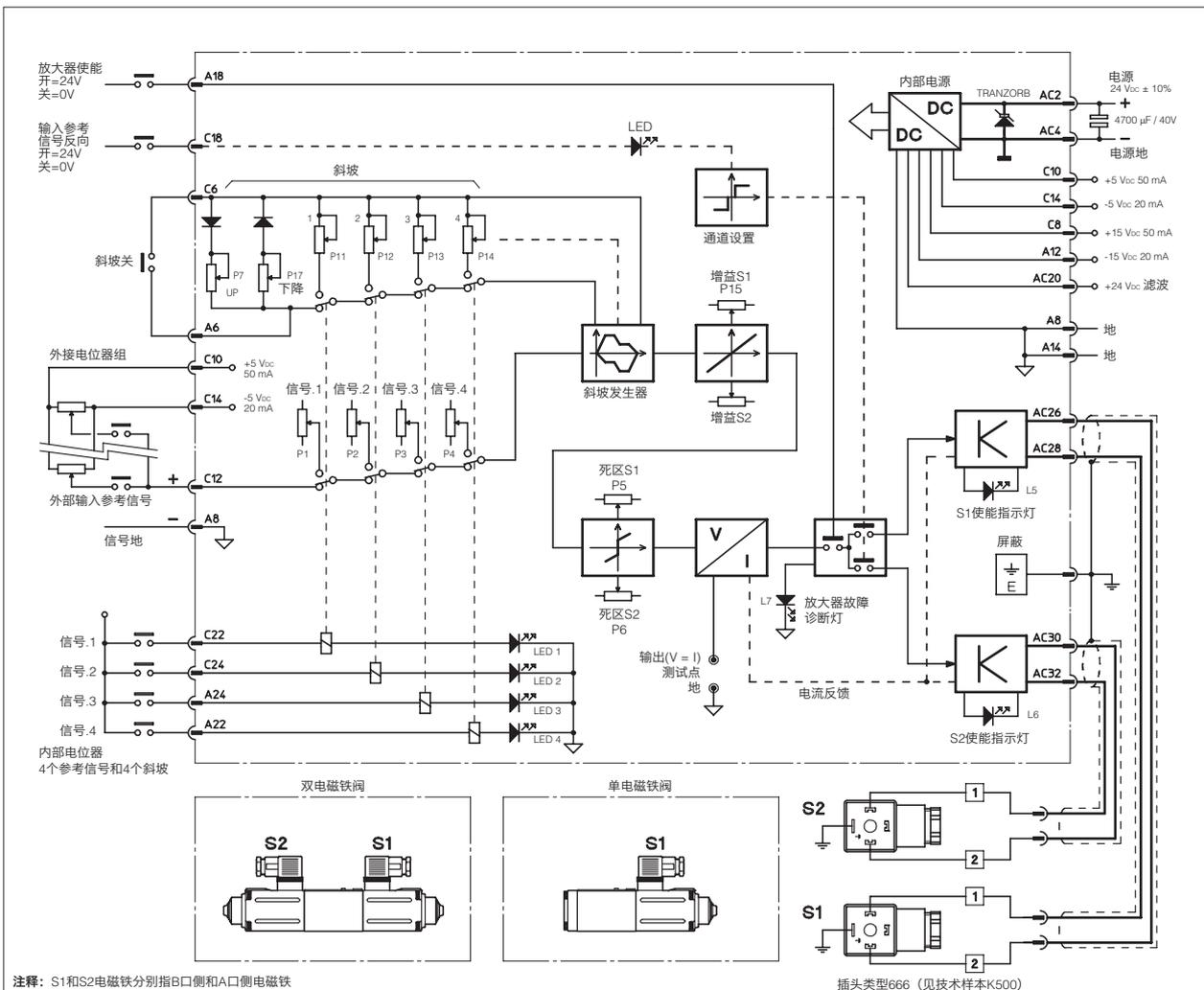
注释：S1和S2电磁铁分别指B口侧和A口侧电磁铁
