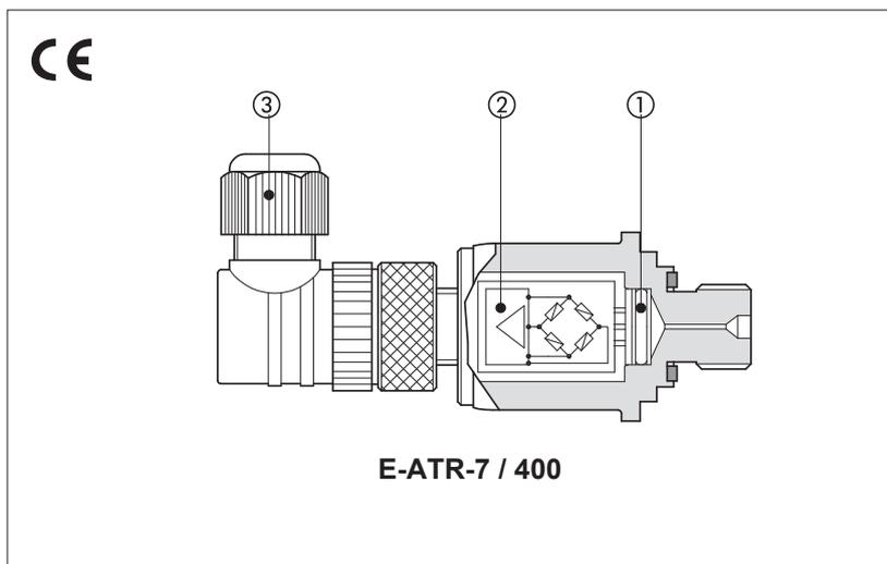
E-ATR-7型压力传感器检测液压油的静态和动态压力，并输出相应的电压或电流信号。
