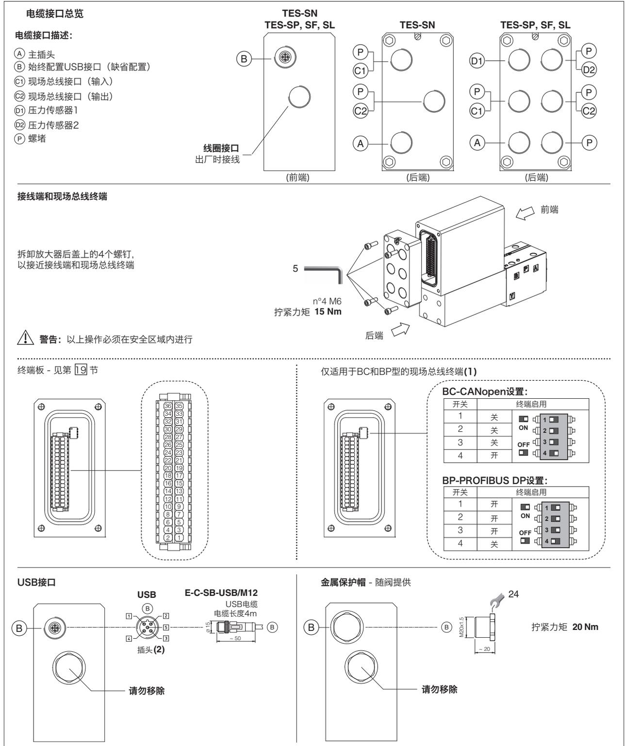
(1) 带有BC和BP现场总线接口的放大器默认为“非终端”。所有开关都已关闭。
