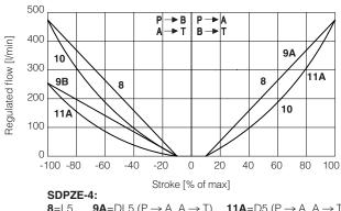
**8**=L5 **9A**=DL5 (P $\rightarrow$ A, A $\rightarrow$ T) **11A**=D5 (P $\rightarrow$ A, A $\rightarrow$ T) **10**=S5 **9B**=DL5 (P  $\rightarrow$  B, B  $\rightarrow$  T) **11B**=D5 (P  $\rightarrow$  B, B  $\rightarrow$  T)
